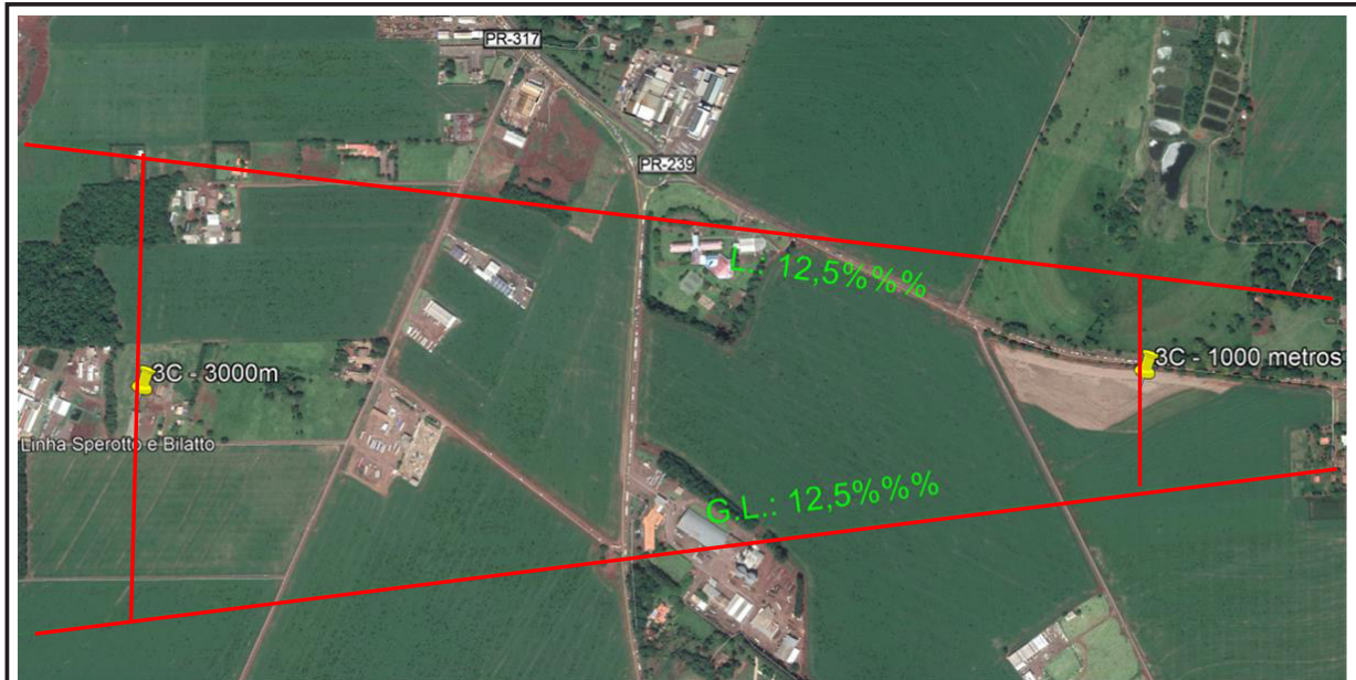
Figura 15 – Superfície de Decolagem Cabeceira 02 – 1000 - 3000 metros
