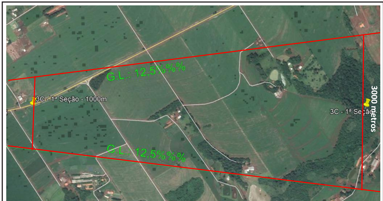
Figura 16 – Superfície de Decolagem Cabeceira 20 – 1000 – 3000 metros
