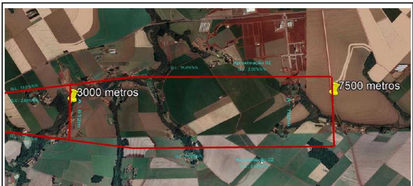
Figura 18 – Superfície de Decolagem Cabeceira 20 – 3000 – 7500 metros
