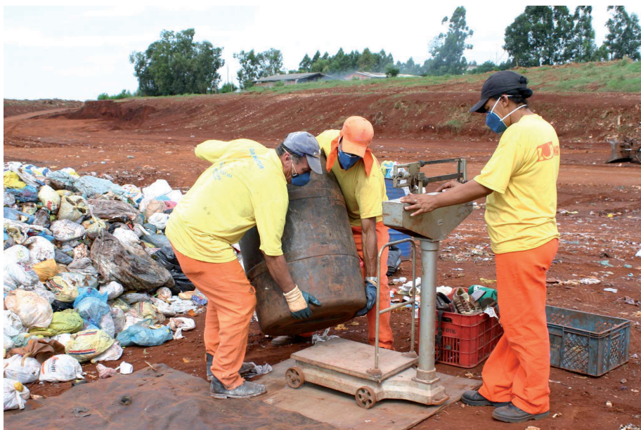
Figura 44 – Pesagem de cada tambor (diferentes tipos de resíduos) para a determinação da composição gravimétrica.
