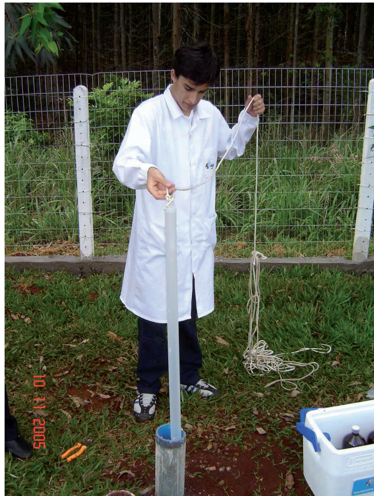
Figura 139 – Amostragem de água do poço de monitoramento a jusante das lagoas de tratamento, no aterro sanitário de Toledo-PR.
