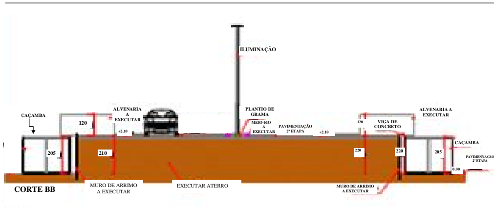
Figura V.16. Corte BB do ECOPONTO. Fonte: Resultados da Pesquisa.
