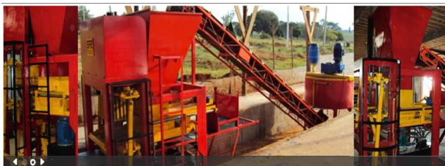
Figura III.44. Produção de equipamentos para o processamento de alguns tipos de RCC (Empresa STARTEC sediada em Toledo-PR).
