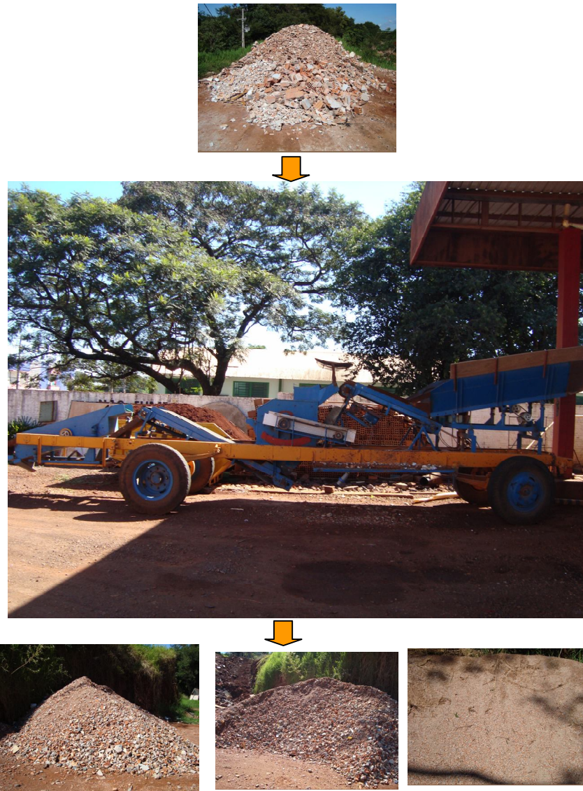
Figura III.45. Utilização de equipamentos para o processamento de alguns tipos de RCC (Empresa Transportes Jomalai Ltda sediada em Toledo-PR).
